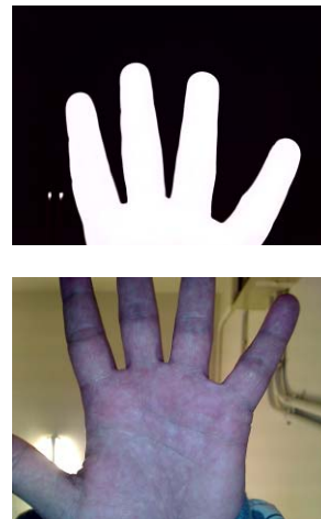
Fig. 8. Imágenes adquiridas por las dos webcams independientes del dispositivo para biometría de la mano sin contacto: arriba en infrarrojo y abajo visible.
