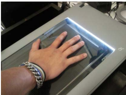
Fig. 3. Ejemplo de uso de un escáner para adquirir la palma de la mano.
